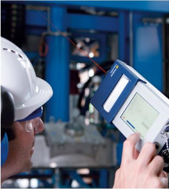
Zustandsüberwachung im Feld aus sicherem Abstand bis 30 m für schwer zugängliche Messobjekte oder Gefahrenbereiche.
