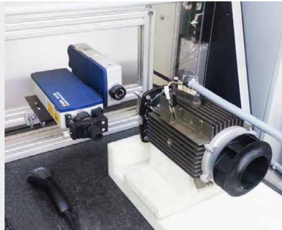
**Verlässliche, berührungslose Fertigungsendkontrollen einzelner Komponenten oder ganzer Baugruppen (hier an einer WILLO-Heizungspumpe mit zwei Industrie-Vibrometern).**
